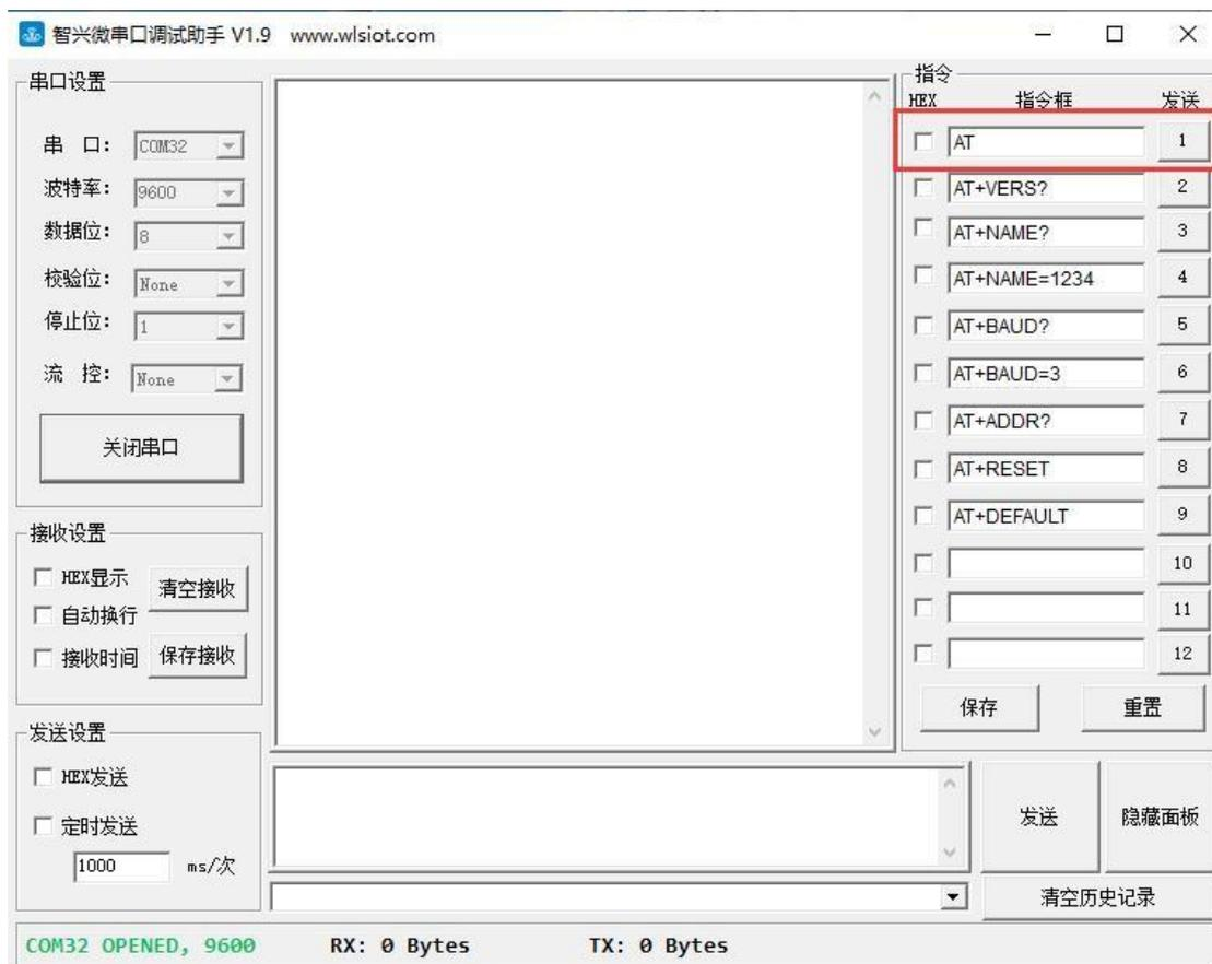
模块串口为 3.3V TTL 电平，使用串口调试助手，按照 9600, N, 8, 1 进行配置，修改 AT 指令时，推荐使用上图智兴微公司自主开发的串口调试助手，右边集合各类 AT 指令，直接发送即可。
