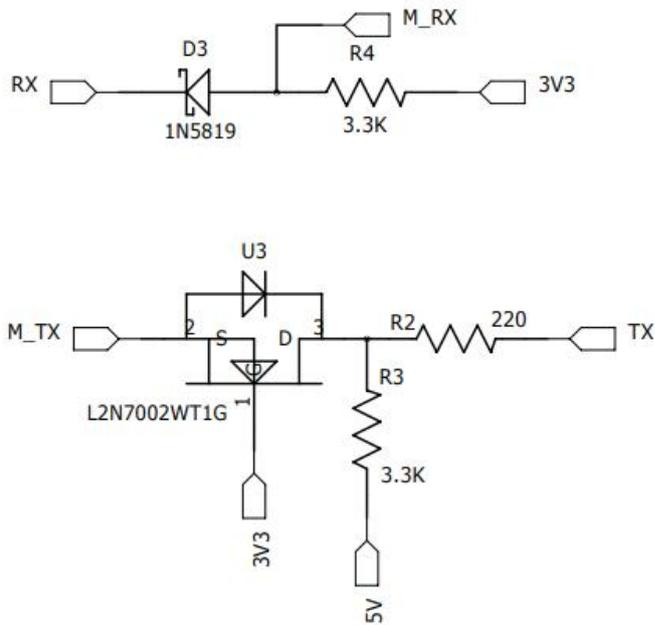
注：如果单片机为 5V 串口连接模块式可参考上图电平转换电路，网络 M\_TX/RX 为模块串口，网络 TX/RX 为单片机串口
