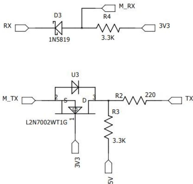
注：如果单片机为 5V 串口连接模块时可参考上图电平转换电路，网络 M\_TX/RX 为模块串口，网络 TX/RX 为单片机串口
