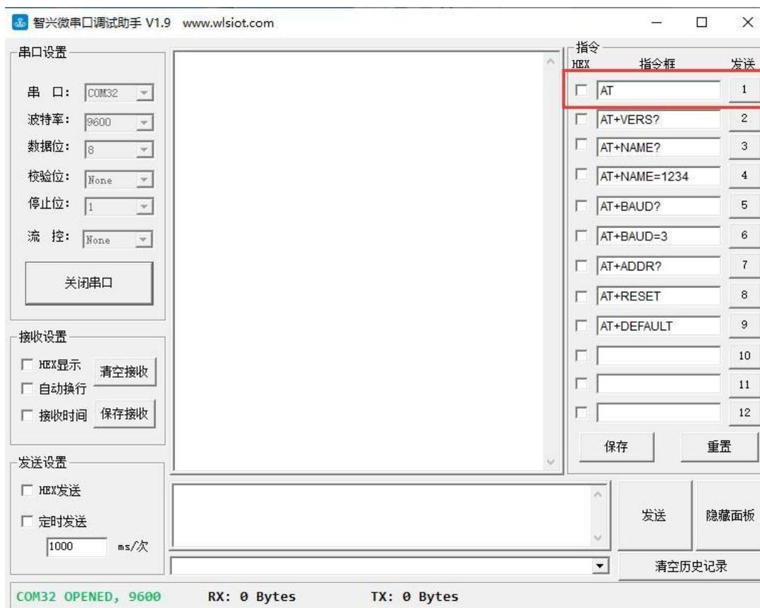
模块串口为 3.3V TTL 电平，使用串口调试助手，按照 9600, N, 8, 1 进行配置，修改 AT 指令时，推荐使用上图智兴微公司自主开发的串口调试助手，右边集合各类 AT 指令，直接发送即可。
